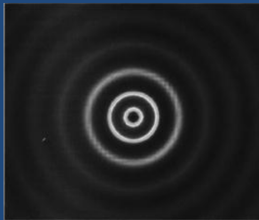
Intensidad de un rayo láser descrita por la función de Bessel J_k(x)
